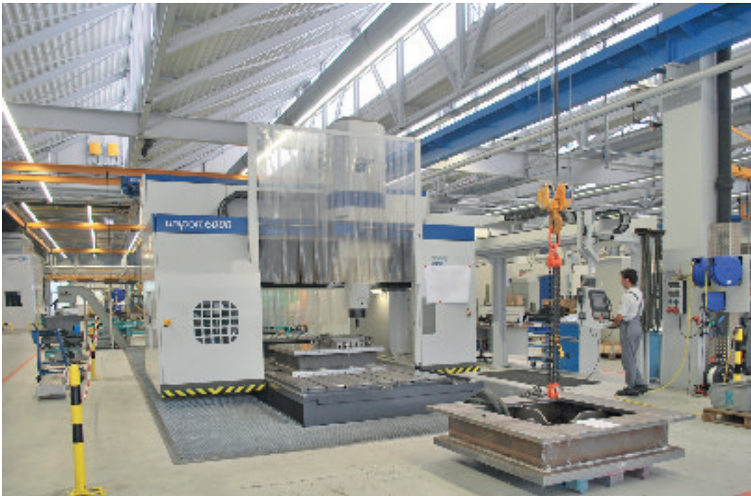
2008 hat KALTENBACH größere Produktionsflächen geschaffen. In der neuen Produktionshalle am Blasiring ist diese Portalfräsmaschine für die Komplettbearbeitung von Großteilen installiert.
