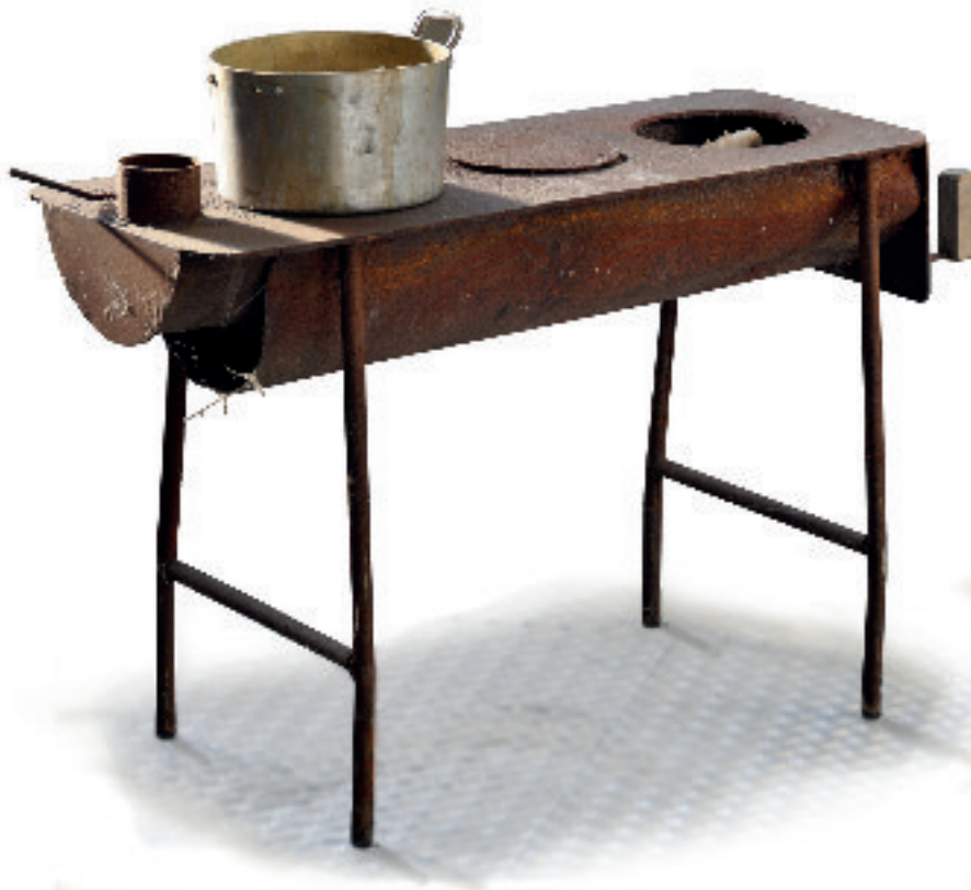
Ein Sparherd (heute im Firmenmuseum), gebaut mit dem wenigen in der Besatzungszeit zu beschaffenden Material. In der besonderen Konstruktion von Hans Kaltenbach kann die Verbrennungsluft vorgewärmt werden, es genügt zum Kochen ein Minimum an Holz. Etwa 200 werden verkauft.
